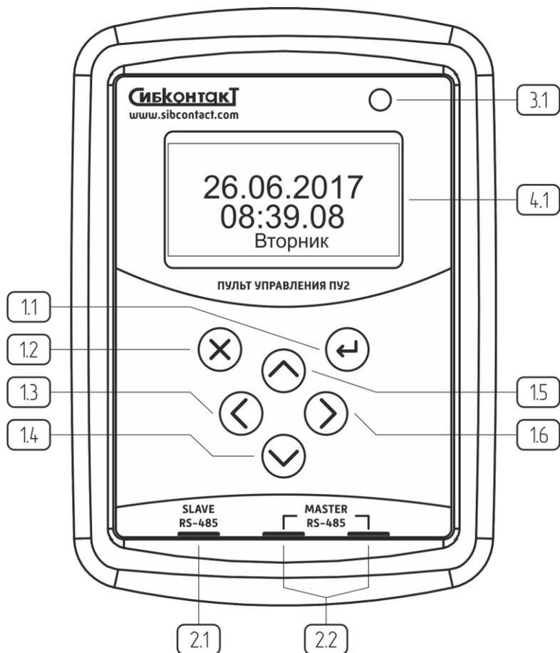
Рис.А2. Внешний вид Пульта с обозначением органов управления и навигации
