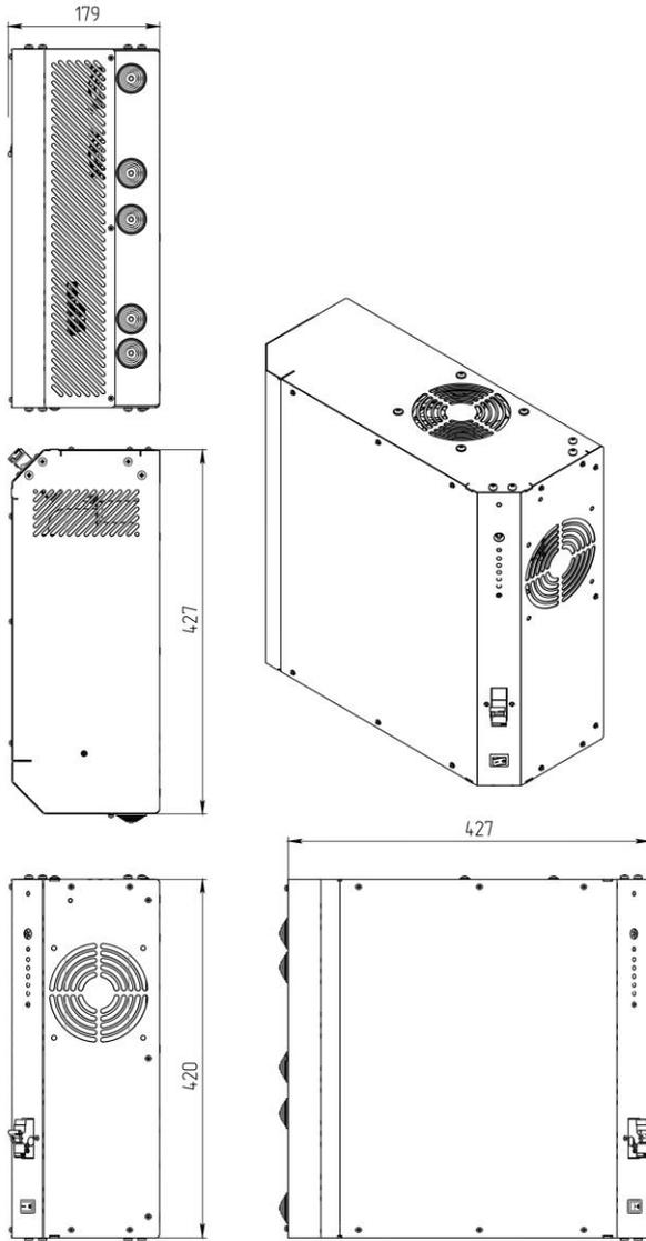
Рис.2. Габаритные размеры
